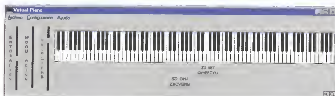
Con el software «Virtual Piano» se puede sustituir mediante el teclado o el ratón a un teclado MIDI.
